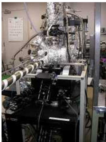
図 2 開発した直交磁化挙動評価用磁気光学カー効果測定装置．本装置は，試料を超高真空中に保ったままの計測が可能であり，本研究の目的である界面効果の詳細を明確にすることが可能となる．
