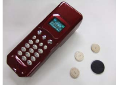
図1 ICタグやバーコードを読み取る携帯端末
