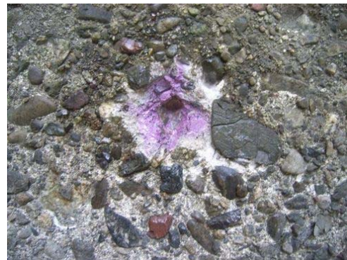
写真-1 はつり試験後の中性化の様子
