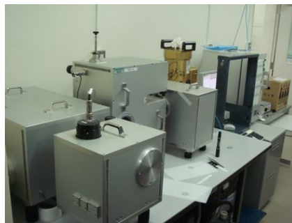
図 1 ミリ波~テラヘルツ波帯域透過スペクトル測定システム
