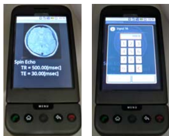
図 6 携帯型 MRI 撮像シミュレータの動作例
