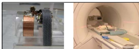
図 1 35 mm 径、巻数 1 の MRM 用ソレノイド型コイル (左)。ソレノイドコイルを使用したラット精巣の MRI 撮像 (右) ラットを静磁場対しに垂直に置く点に注意。
