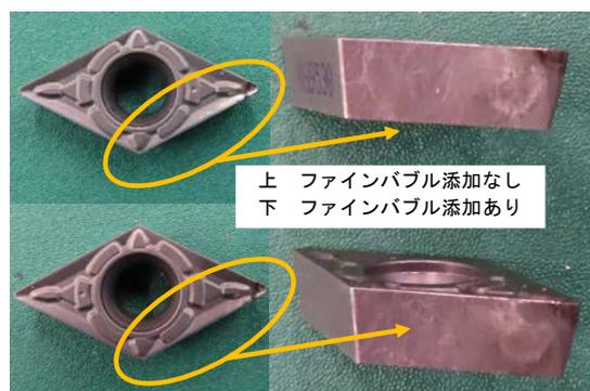
図 2 ファインバブル添加有無による工具摩耗の比較
