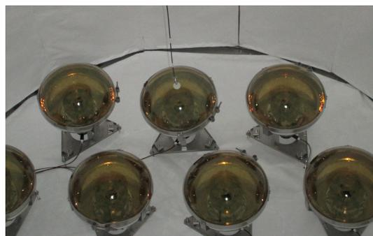
LED光源による光センサー較正
