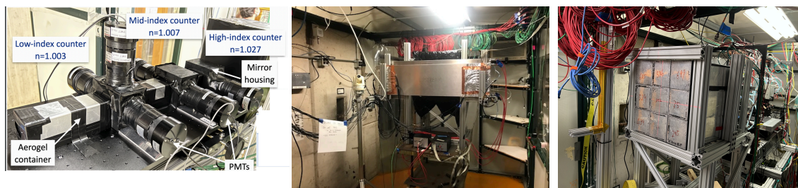
図2。本研究で開発した検出器：（左から）Beam Aerogel counters（3台），RPC(2台），鉛ガラス検出器（9台）
