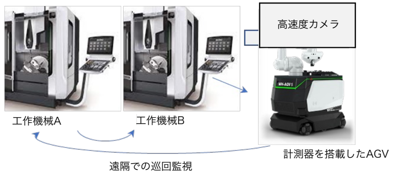
図 4. 高速カメラによる振動計測
