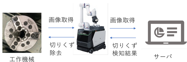
図 5. 切りくず堆積検知
