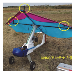
図5 カイトプレーンと GNSS アンテナ
