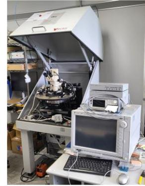
図 2 高精度メモリ特性評価システム。
