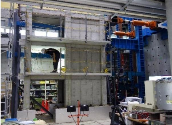
図3 試験体の水平載荷時の様子
