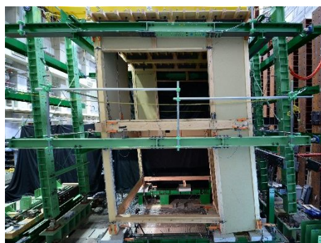
京町家を模した立体架構の静的水平加力実験（左： R=1/15\text{rad} 、右： R=-1/15\text{rad} ）
