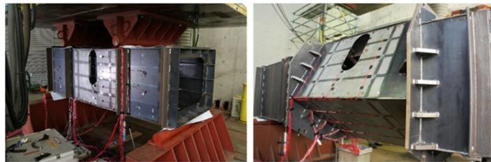
図 4 直立および傾斜損傷ガーダー模型
