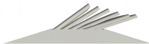
図-4 フレキシブルパイプの変形後形状
