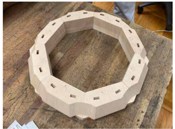
NC 加工後手を加えて完成した新調部品
