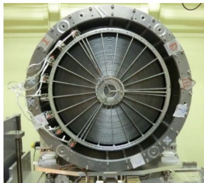
図1: SPring-8において、反射フォイルを位置調整した際のFFAST望遠鏡。口径450mm。
