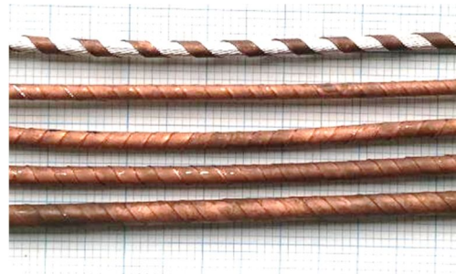
図 10 試作した各種 REBCO ケーブル
