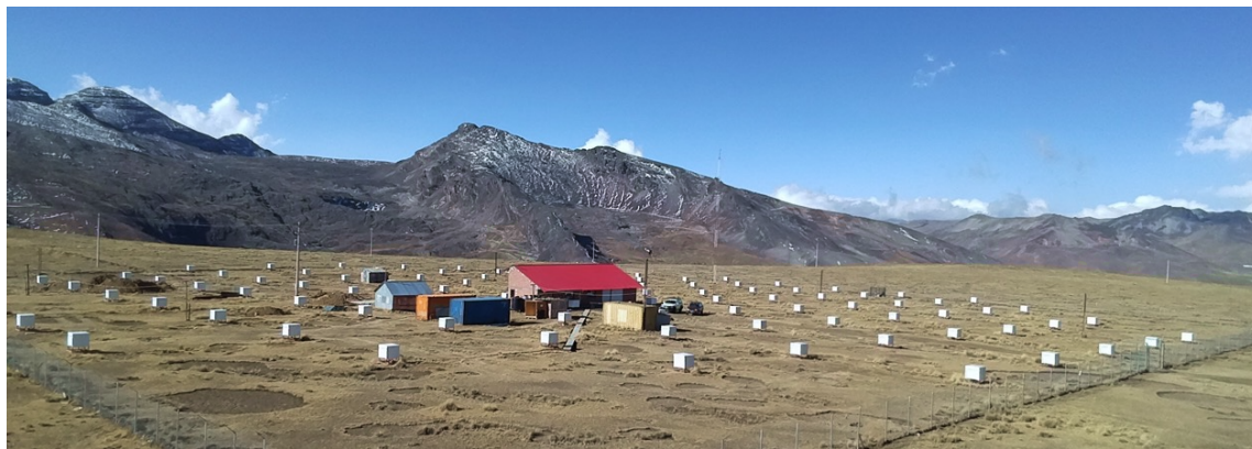
図 1 南米ボリビア・チャカルタヤ山中腹(標高 4740m)で行われている ALPAQUITA 実験の全景写真。白い四角は 97 台のシンチレーション検出器。赤い屋根の建屋にデータ収集システムなどのエレクトロニクスが収められている。
