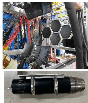
図 8 中性子検出器。(上) プラスチックシンチレーターと(下)リシウムガラスシンチレーター。
