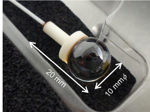
図3. 試作ボールレンズ光学測定ヘッド。
