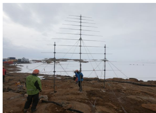
図5. 昭和基地に設置し、観測運用を開始したスペクトルリオメータ。
