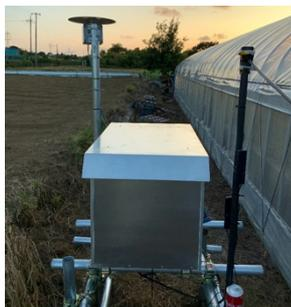
図1 関東圏3次元雷観測ネットワークを構成する干渉計の配置図(左)および、同観測装置外観(右)
