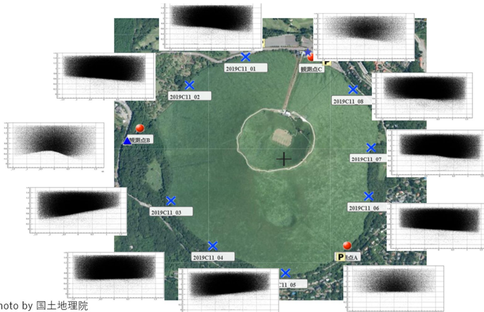
図 2：大室山航空写真（国土地理院）と、大室山周辺 11 箇所に設置した原子核乾板によるミュオン検出器で得られたミュオンの方向分布。
