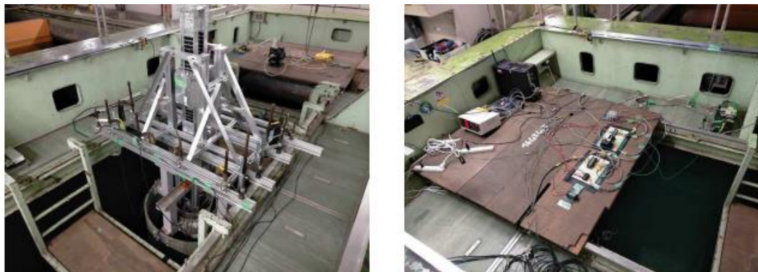
図1 インバータを用いた水槽試験の様子
