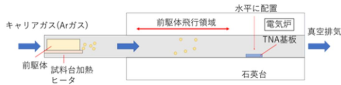
図 5. 管状炉熱 CVD 装置の概略図 .
