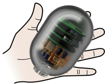
図 1 超小型 REE センサの概念図。ナノトランジスタ、マイクロ送液制御ユニット、小型電装系、小型耐圧容器が集積化されている。
