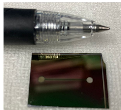
図 3 マイクロ加工技術によって製作した減圧用マイクロ流体デバイス
