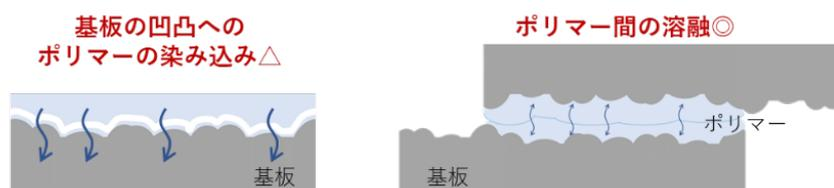
Figure 3. 基板凹凸へのポリマー溶液の染み込み (左) とポリマー間の熔融 (右) のイメージ図
