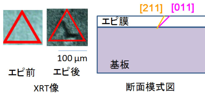
図3 エピタキシャル膜/基板 界面から2本転位が発生・成長している例
