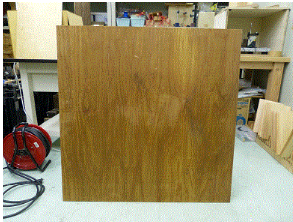
写真1 作成した合板(厚さ 12mm)
