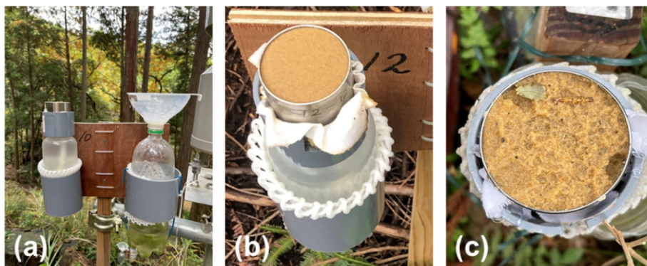
写真1 雨滴衝撃観測状況 (a)樹冠通過雨量・雨滴衝撃エネルギー観測装置、(b)降雨前スプラッシュカップ表面、(c)降雨後スプラッシュカップ表面
