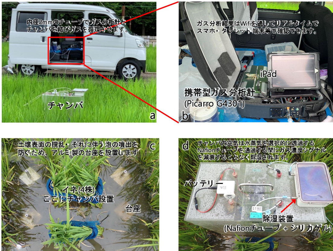
図1 携帯型メタン計を用いた水田からのメタン排出量の観測方法
