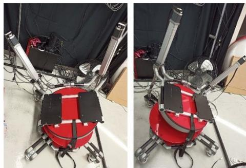
図 2 ヒンジ機構による揺動結果
