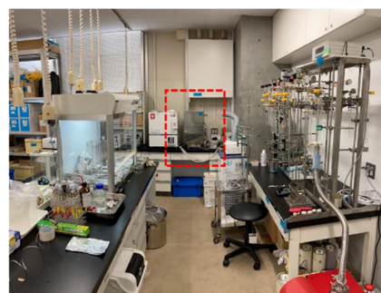
図2 東京大学大気海洋研究所に設置したDOC-14分析用前処理ユニット。赤枠はUV照射部。
