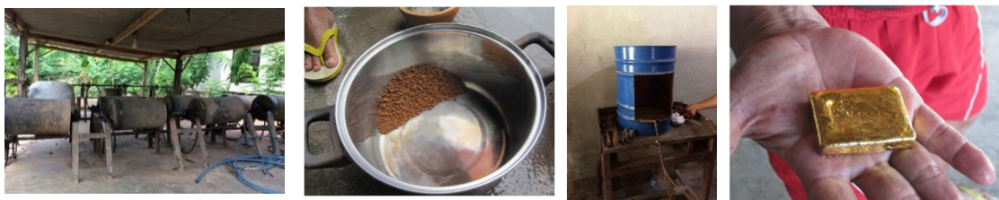
図 3 Milling input 7.5cc Mercury 図 4 Amalgam Mercury + Gold 図 5 Combustion by gas burner 図 6 Gold 110g
