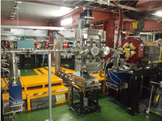
図 8. KEK-ATF に導入・設置を完了した極短周期アンジュレータ
