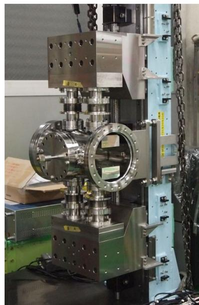
図 2. 光源性能評価試験に用いる極短周期アンジュレータ本体。面間 280mm のチェンバ内に見えるマグネット取付台に周期磁場を書き込んだ永久磁石を取付ける。
