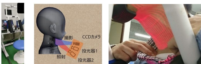
図2 運動解析装置(左)と嚥下時の撮像(右)
