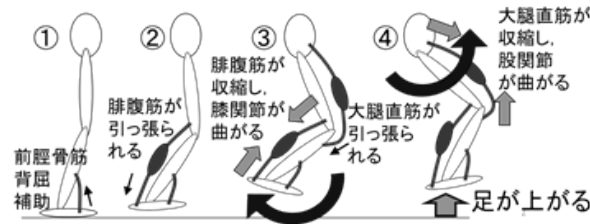
図 2 足関節補助だけで足が上がる原理
