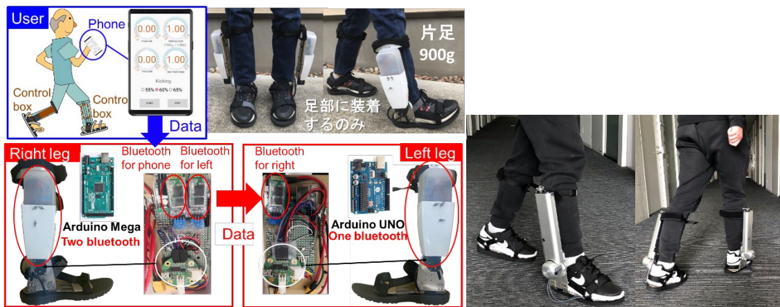
図 4 開発した足部のみ取り付けの歩行補助機の 1 次試作機, 2 次試作機
