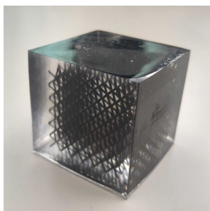
図5: 3Dプリンタで造形した負熱膨張フィラー人工構造体コンボジット
