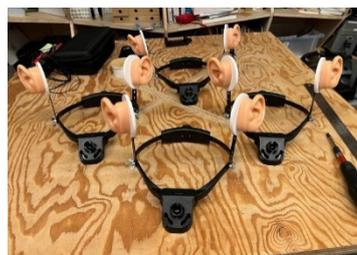
図5 制作したバイノーラル録音装置
