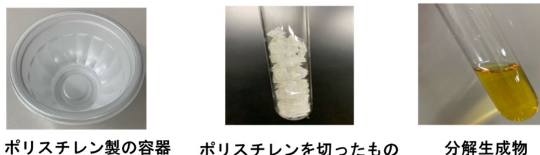
図 4 . ポリスチレンの熱分解 (左)原料のポリスチレン (中)有機溶剤(アセトン)により減容化しさらに細かくちぎったもの (右)熱分解反応により得た試料(蒸留前)
