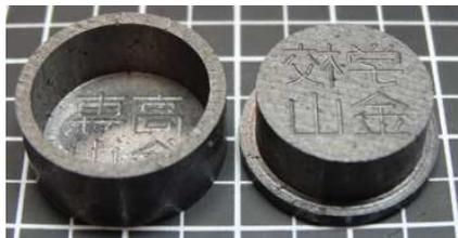
図 8. 製作したカーボン鋳型
