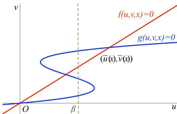
左図の  $(\bar{u}(x), \bar{v}(x))$  は各  $x$  に対し拡散を無視した常微分方程式系の安定な平衡点である. その近傍に反応拡散系 (P2) の安定な定常解  $(\varphi(x), \psi(x))$  が存在する.  $(0, 0)$  も安定な定常解である. これら二つが背景パターンである.
