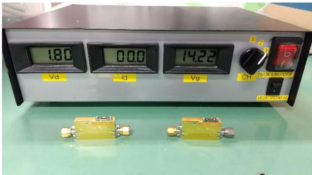
図1. 本事業で購入した世界最高感度の低雑音冷却増幅器(手前)と自作した低雑音冷却増幅器のバイアス電源(奥)。
