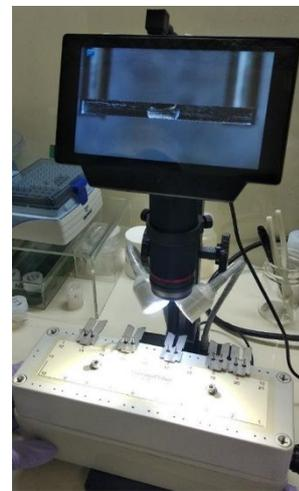
図2 マイクロスコープによるフィラメントローディング状態管理
