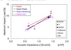
全塑性, ひずみ硬化モデルで不一致が確認された.衝撃エネルギーから推定された見かけのヤング率を分析した結果, 金属の気泡崩壊衝撃荷重による損傷は疲労破壊が支配的となるのに対し,ポリマーの場合は降伏の影響を強く受けることを確認した.
