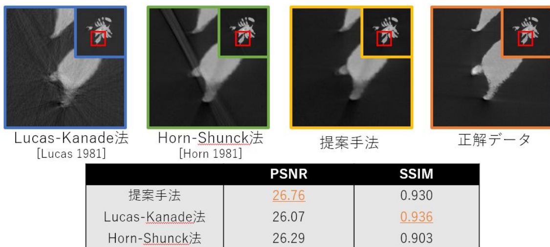
図4 リアルタイム3次元計測データに対する本研究と他手法の比較。
