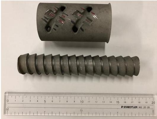
図1 金属3Dプリンタで試作したボールねじ
