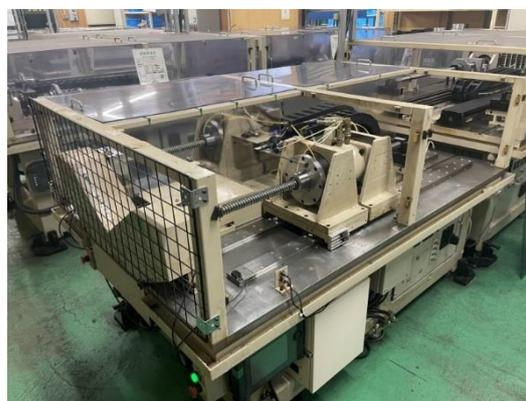
図 9 ボールねじ走行試験装置写真
