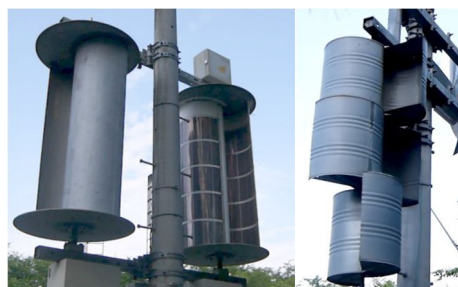
図1 サボニウス型風車(垂直軸型)
